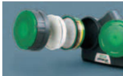
Kompakte TabTec® Filter-Technologie besteht aus einer Kohletablette anstelle losen Kohlegranulats. Um die jeweils notwendige Schutzstufe zu erreichen, können die drei Filtertypen auch kombiniert werden. Es brauchen weniger Filtertypen vorgehalten zu werden.
