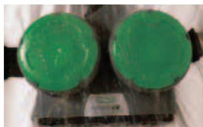
Der Duschtest beweist es. Das Gerät kann ohne zusätzliche Teile oder Vorbereitungen während der Dekontamination vom Träger getragen werden.
